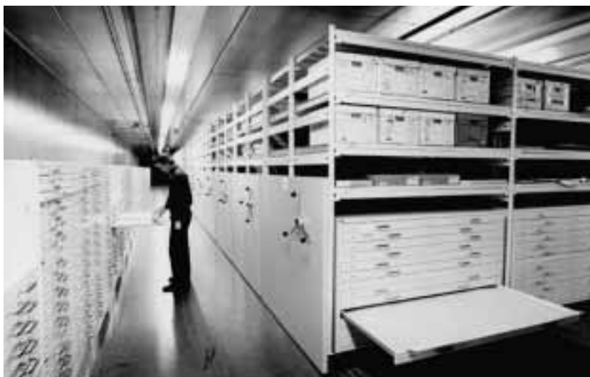
Meubles à plans superposés : noter les socles, les poignées en disposition alterne, le rabat mobile à l'avant des tiroirs. Archives nationales du Canada, photo Denis Gagnon. ©
